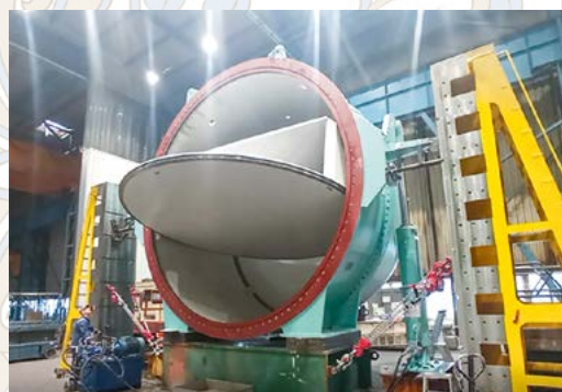
在安德里茨匈牙利制造基地做压力钢管隔离阀 (PIV) 测试
