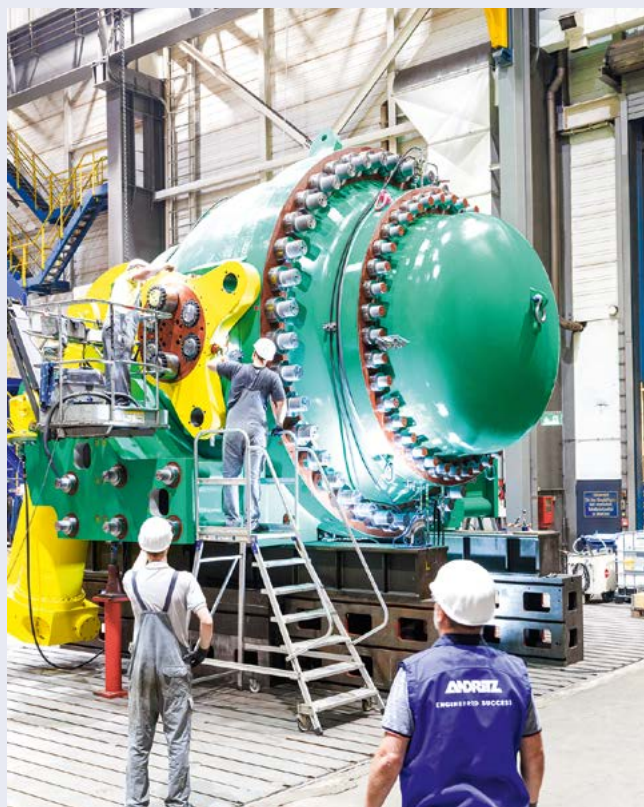
2022年秋,在客户的见证下,对Dinorwig水电站的第一个球阀进行压力试验和工厂验收
