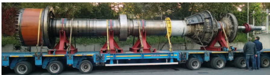
▲ Transport de la ligne d'arbre (longueur 14,8 m, poids : 95 tonnes)
