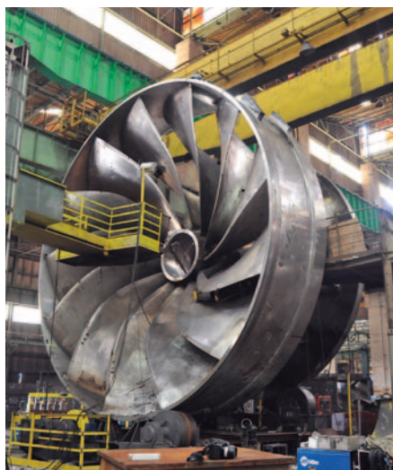
▲ Une roue Francis en cours de fabrication
